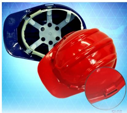
Capacete de segurança com aba frontal, copa com estrias, injetado em polietileno de alta densidade e com slot. Suspensão em peça única injetada em polietileno de baixa densidade. Tira absorvente de suor.
